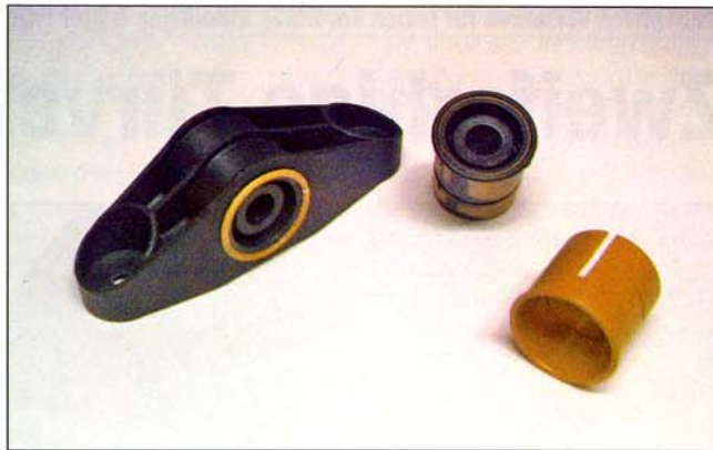
Entkoppeltes Lager für Mercedes-Schaltung: links der Lagerbock aus PA 6.6 GF 30, rechts die Vestoranbuchse, in die EPDM-Elastomer direkt haftend eingespritzt wird Fotos: TVN innoject
